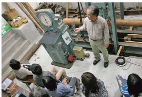
解体材の曲げ強度測定実験の様子
