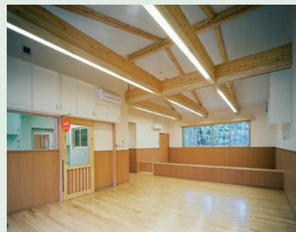
め木造を希望する声が関係者の中に多かったため、木造を中心とした各種工法を、基本性能とコストの面から検討しました。その際、平嶋義彦生命農学研究科教授のご助言をいただき、建物の主要な構造部材に集成材を使用し、構造計算により地震などの自然災害に対する建物の安全性を確保する工法（SE 構法）を採用することとしました。
