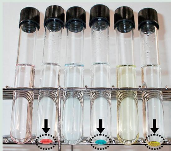
写真2 イオン液体。左側の試験管では希薄な色素が、矢印で示したイオン液体に高度に抽出濃縮されている。
